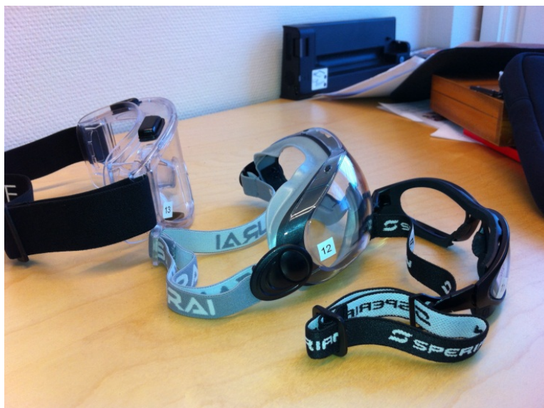
Figur 5 Testede Goggles. Forrest nr 11, deretter 12 og bakerst nr. 13. Bildet viser den store variasjonen i bredden på stroppebåndet. Nr 13 har et svært bredt bånd. I tillegg viser bildet den spesielle festeanordning til stroppen på Goggle 12, som strekker seg langt inn mot øret.
