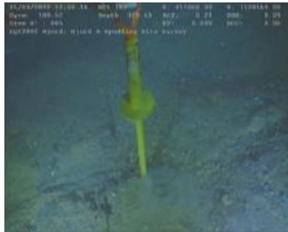
Figur 6-32 Spudding Site S4B sør for brønn A-01H & A-02H
