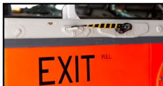
Åpning i nødutganger ved piloter
