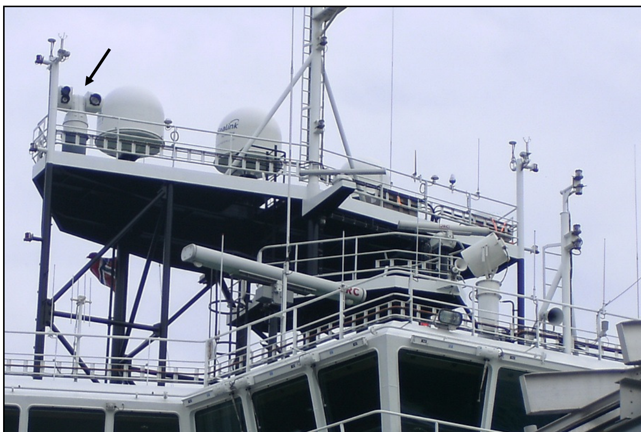
Områdeberedskapsfartøyet Stril Herkules, med oljedeteksjonsradar og infrarødt kamera.
