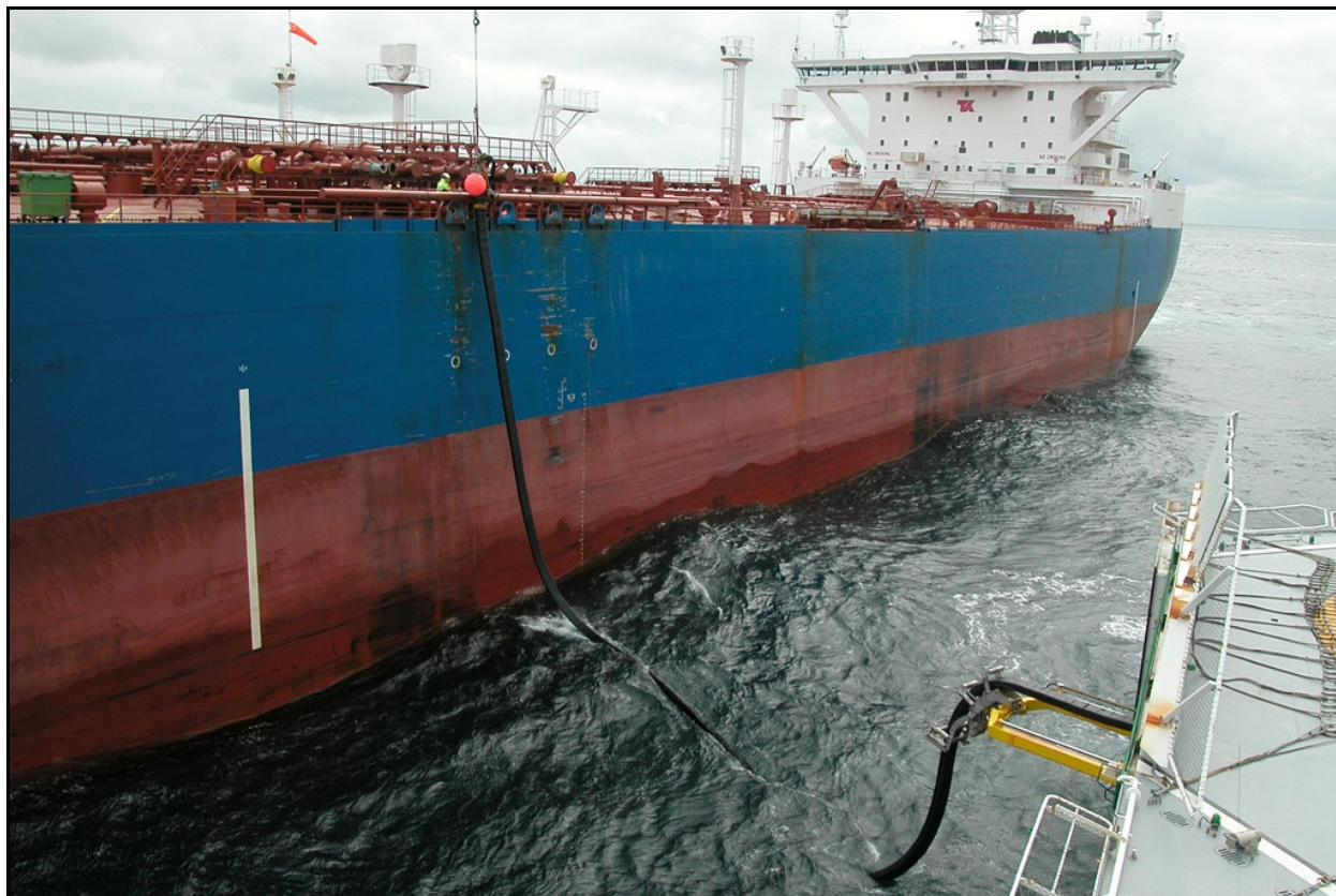
Overføring av oppsamlet olje mellom to oljevern fartøy og tankskip (Foto: NOFO)
