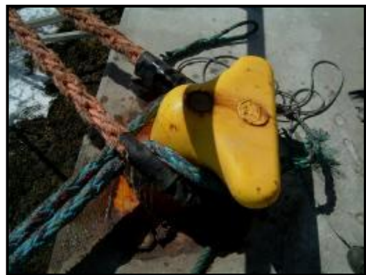
Bilde 2 Den siste trossen (den blå trossen) føres gjennom løkka til den trossen, som allerede ligger rundt pullerten (den røde trossen) før den legges rundt pullerten
